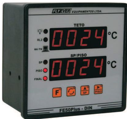
O FE50Plus-DIN é um dos instrumentos de indicação e controle microcontrolado da FLYEVER. Este modelo é aplicado em supervisão e controle de temperatura em processos de fabricação de cerâmica vermelha que necessitam controle e indicações com alarmes, sinalizadores e gráficos.
